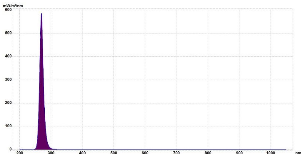
Rycina 4. Widmo modułowego promiennika UV-C LED model UVM002A-0401U1-RM (złożonego z czterech diod) o łącznej mocy 9W (Citizen Electronics Co., Ltd., Yamanashi, Japonia).
